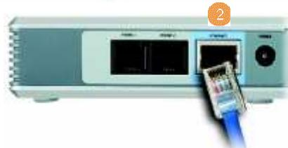
**Paso 3:** Conecta el otro extremo del cable de red a una boca libre de su router, switch o hub, ADSL (puerto Ethernet)
