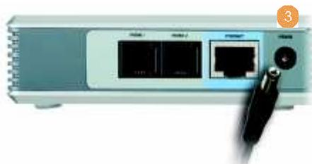
Compruebe que el terminal telefónico está colgado. En aproximadamente 60 segundos, el adaptador se registrará automáticamente en la red de servicio y cuando levantes el auricular del teléfono oirás tono de llamada.
